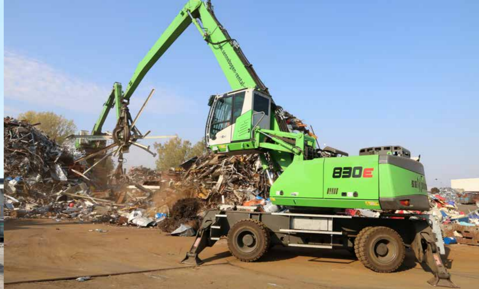
830 M - with orange peel grab - scrap handling; Germany 830 M - mit Mehrschalengreifer - Schrottschlag; Deutschland
