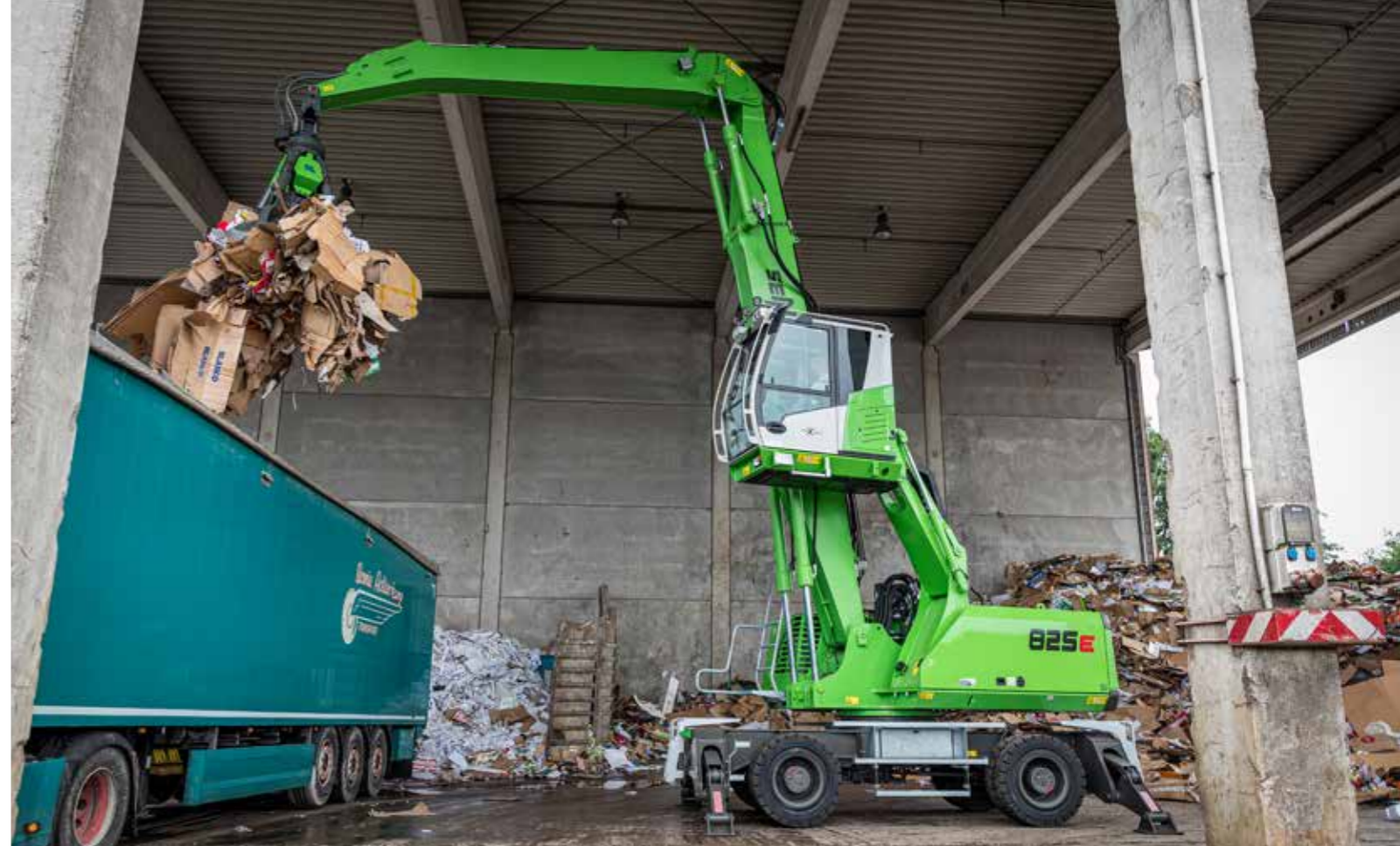
825 M - with orange peel grab - truck loading with used paper; Germany 825 M - mit Mehrschalengreifer - LKW Beladung mit Altpapier; Deutschland
