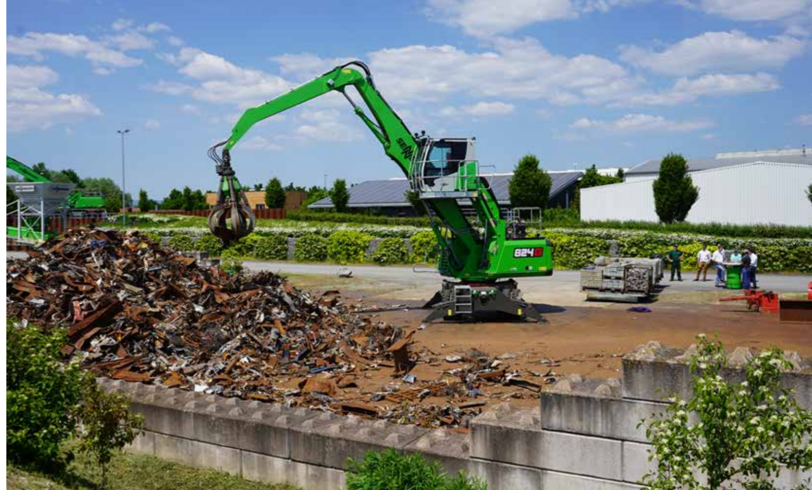
824 M - with orange peel grab - scrap handling; Germany 824 M - mit Mehrschalengreifer - Schrottschlag; Deutschland
