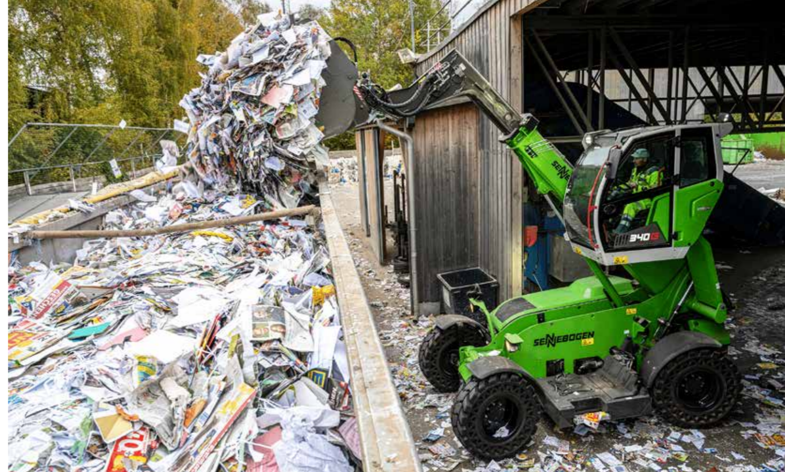
340 G Telehandler - loading of a container with used paper; Germany 340 G Teleskoplader - Container-Beladung mit Altpapier; Deutschland
