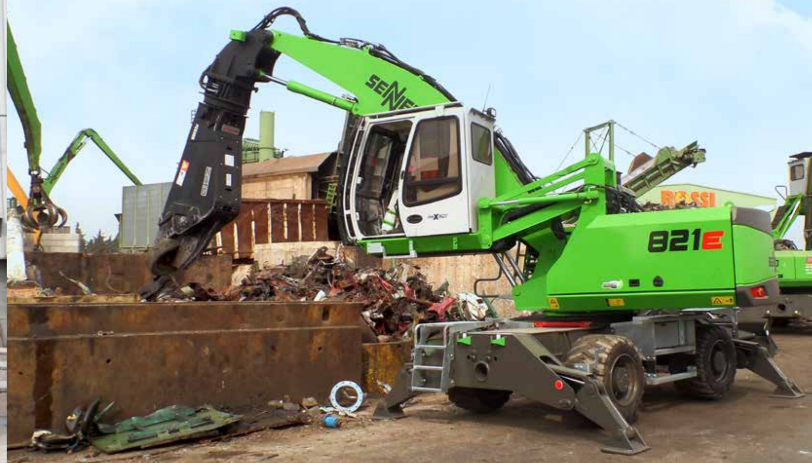
821 M - with 4 t scrap shear - shredding of scrap; France 821 M - mit 4 t Schrottschere - Zerkleinern von Schrott; Frankreich
