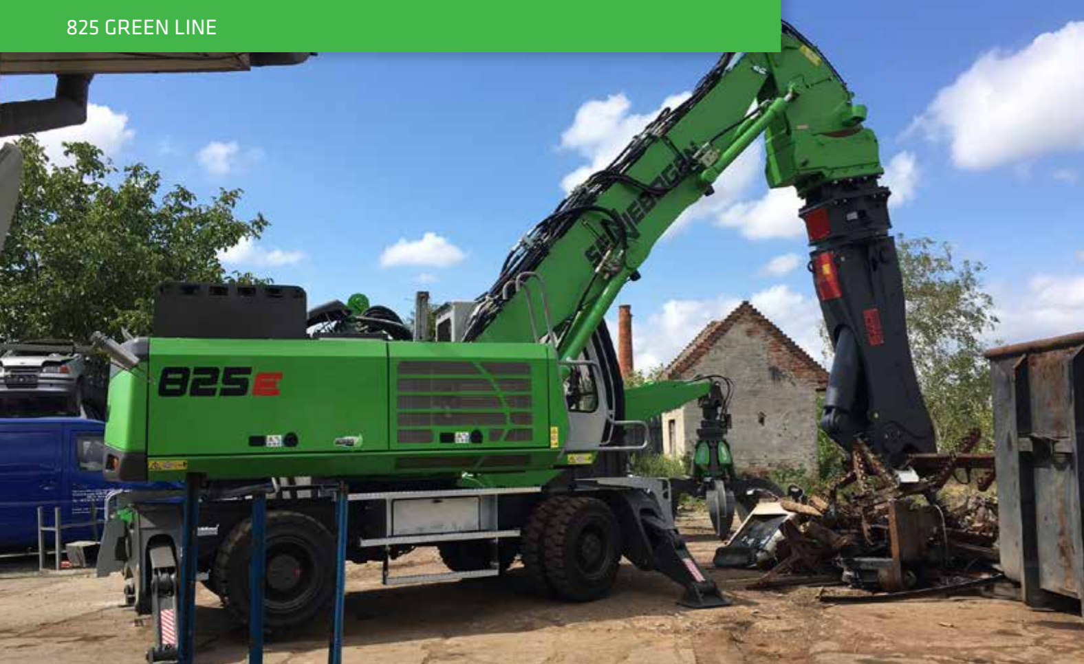
825 M – vario tool with scrap shear and orange peel grab – scrap handling; Hungary 825 M – Vario Tool mit Schrottschere und Mehrschalengreifer – Schrottschlag; Ungarn
