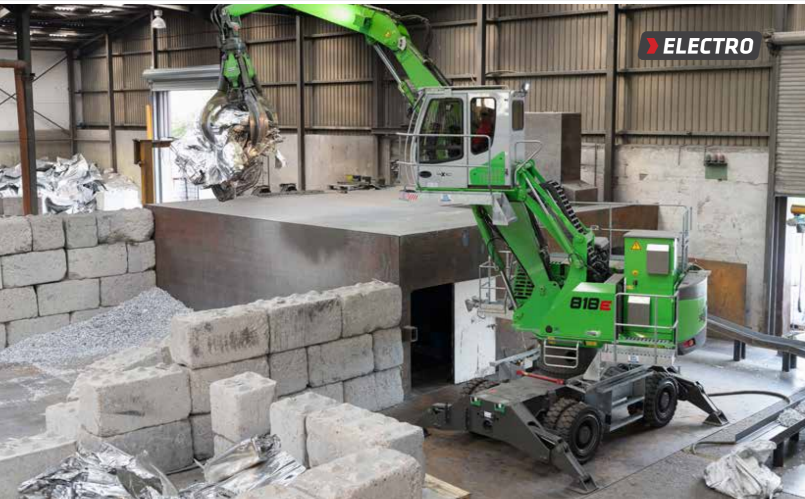
818 M Electro – with original SENNEBOGEN orange peel grab – feeding of a baling press; Germany 818 M Elektro – mit original SENNEBOGEN Mehrschalengreifer – Beschickung der Ballenpresse; Deutschland
