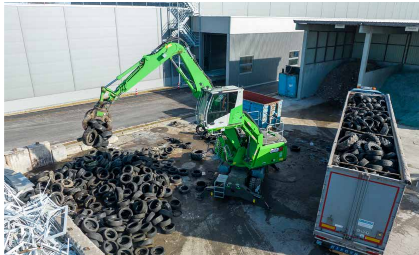
822 M - with sorting grab - loading of a truck with used tires; Austria 822 M - mit Sortiergreifer - LKW-Beladung mit Altreifen; Österreich
