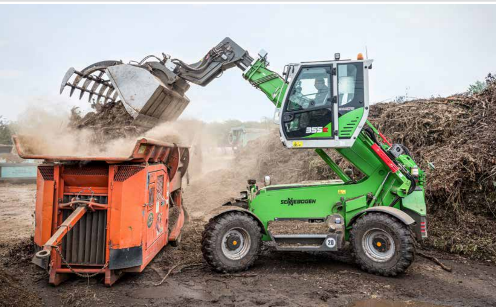
355 E Telehandler - feeding a shredder with bark mulch; Germany 355 E Teleskoplader - Schredderbeschickung mit Rindenmulch; Deutschland
