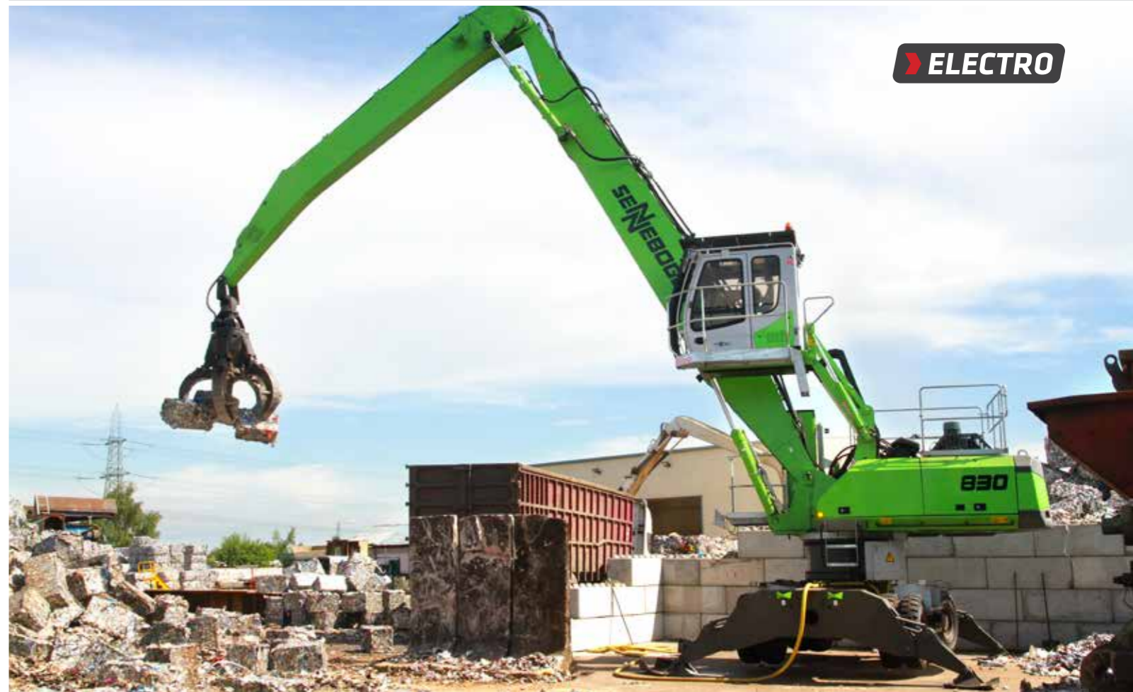
830 M Electro - with orange peel grab - loading of steel bales; Great Britain 830 M Elektro - mit Mehrschalengreifer - Verladung von Stahlballen; Großbritannien
