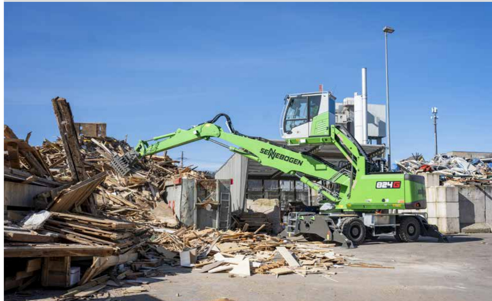
824 M - with sorting grab - sorting of waste wood; Switzerland 824 M - mit Sortiergreifer - Sortieren von Altholz; Schweiz
