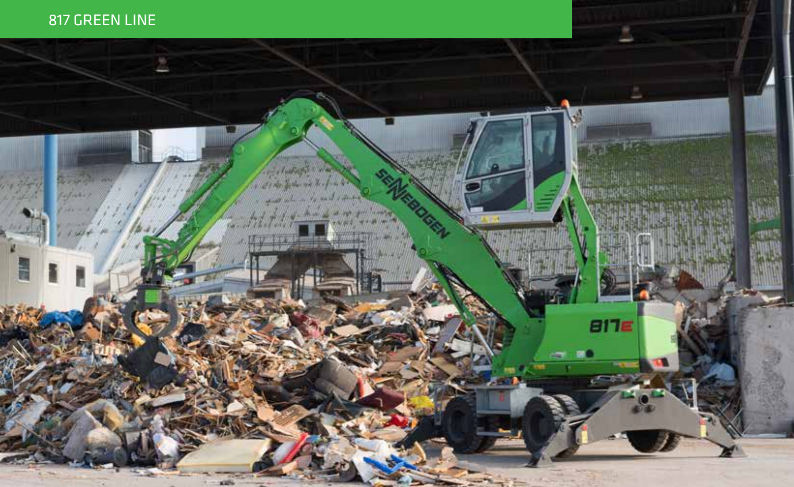
817 M - with original SENNEBOGEN sorting grab - sorting works outdoor; Germany 817 M - mit original SENNEBOGEN Sortiergreifer- Sortiertätigkeiten im Freien; Deutschland
