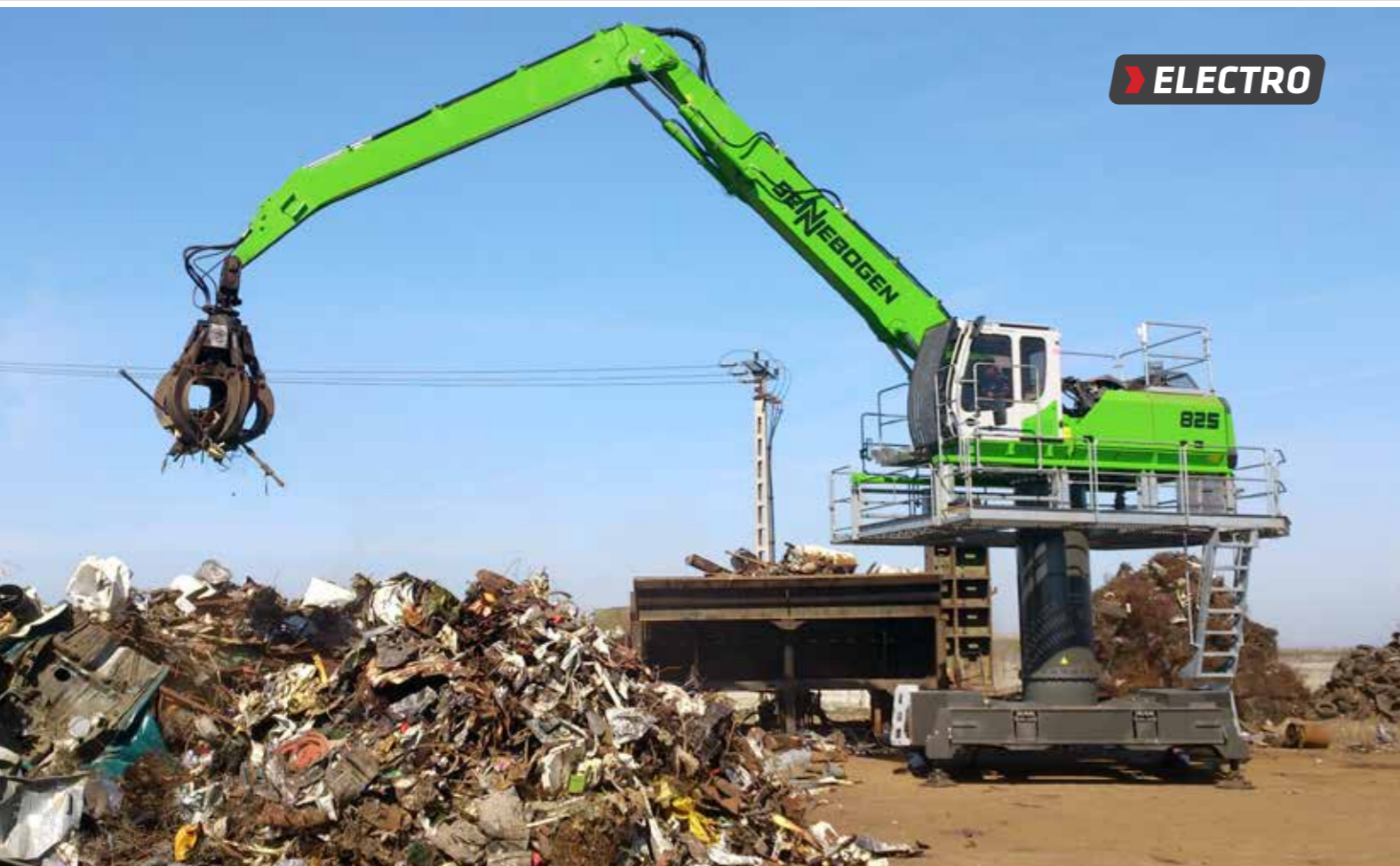
825 stationary Electro – with orange peel grab – feeding a scrap shear; Hungary 825 stationär Elektro – mit Mehrschalengreifer – Beschickung einer Schrottschere; Ungarn
