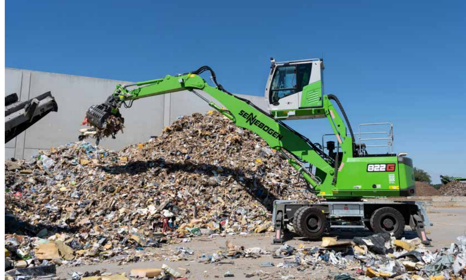
822 M - with sorting grab - sorting of waste; Germany 822 M - mit Sortiergreifer - Sortierung von Abfall; Deutschland
