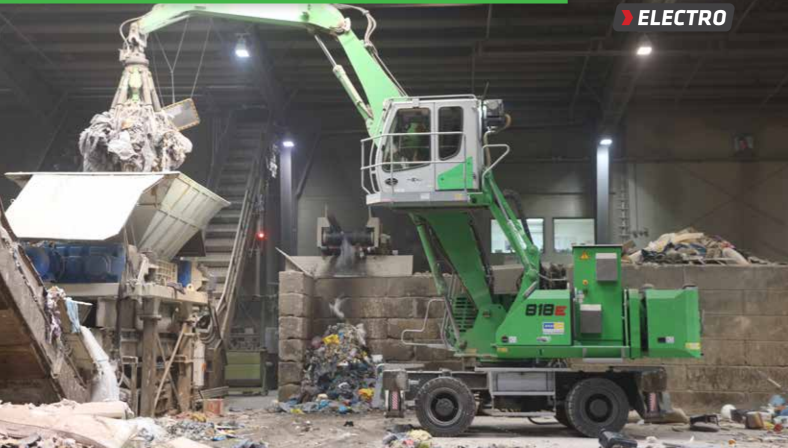
818 M Elektro – with sorting grab – loading of shredder indoor - machine with powerpack solution; Germany 818 M Elektro – mit Sortiergreifer – Schredderbelandung in der Halle - Maschine mit Powerpack-Lösung; Deutschland
