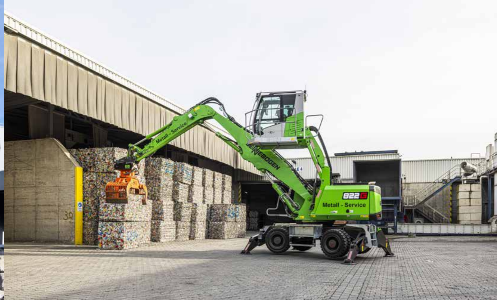
822 M - sorting of aluminum bundles with sorting grab and quick change grab; Germany 822 M - Sortierung von Aluminiumballen mit Sortiergreifer und Schnellwechsler; Deutschland
