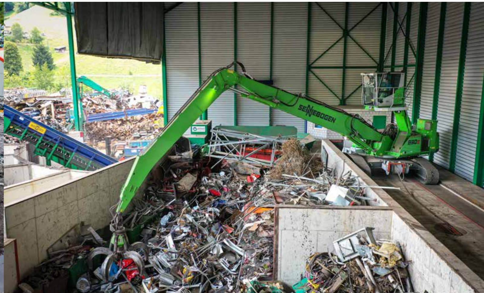
830 R Electro - with orange peel grab - scrap recycling; Switzerland 830 R Elektro - mit Mehrschalengreifer - Schrottreycling; Schweiz
