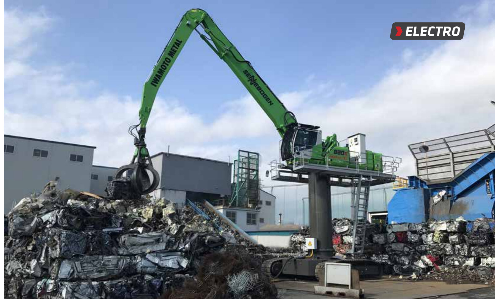
830 R Electro - with orange peel grab - scrap handling; Japan 830 R Elektro - mit Mehrschalengreifer - Schrottschlag; Japan
