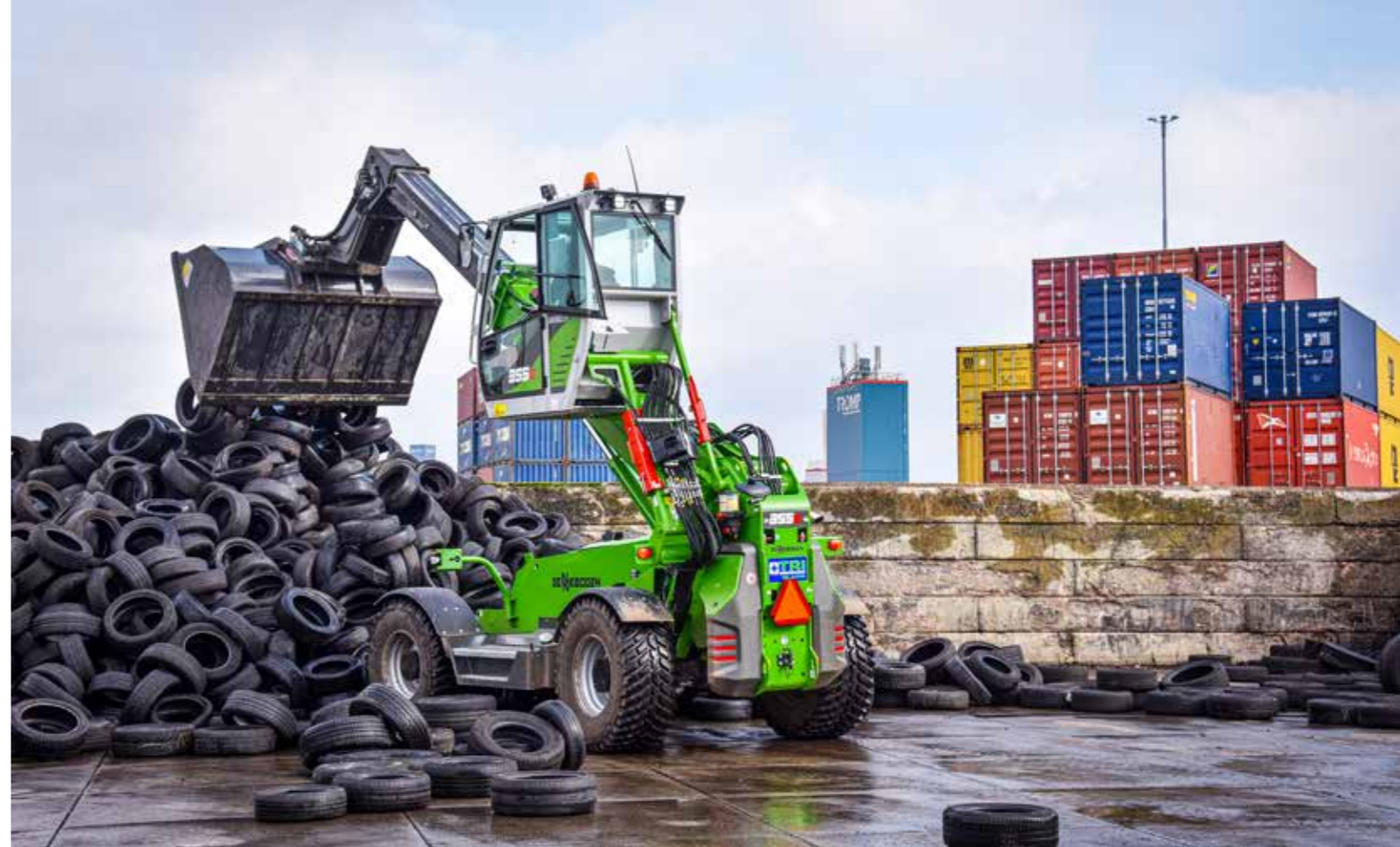
355 E Telehandler - handling used tires with bucket; Netherlands 355 E Teleskoplader - Umschlag von Altreifen mit Schaufel; Niederlande
