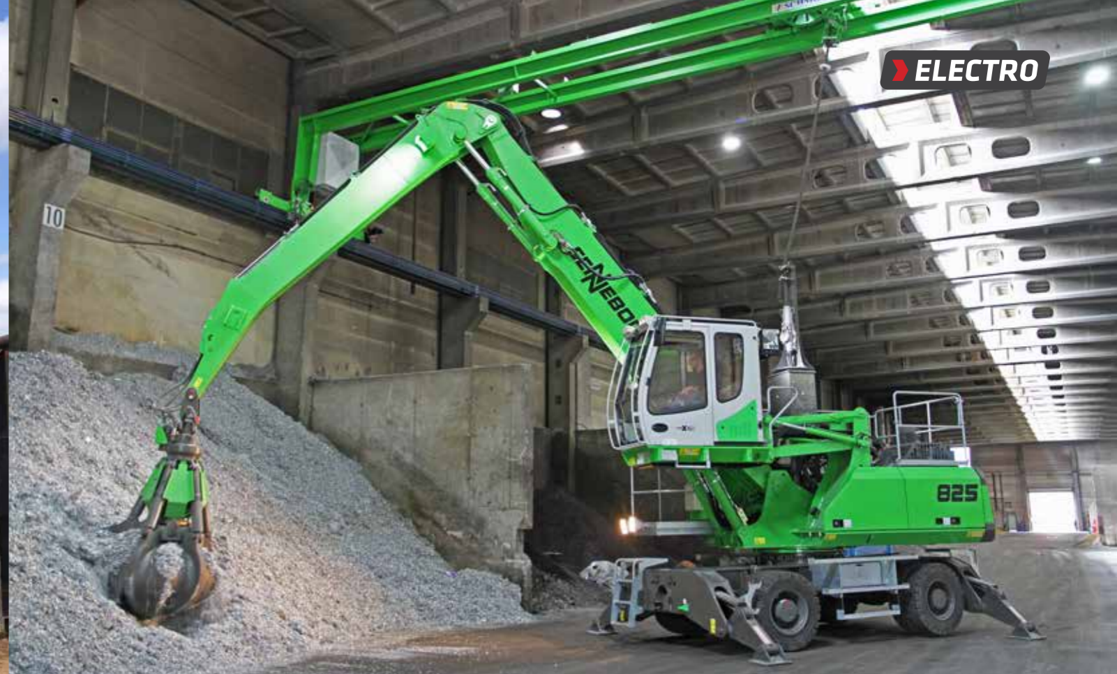
825 M Electro – with orange peel grab – scrap recycling indoor with ceiling power supply; Germany 825 M Elektro – mit Mehrschalengreifer – Schrottschlag im Halleneinsatz mit Deckenstromzuführung; Deutschland
