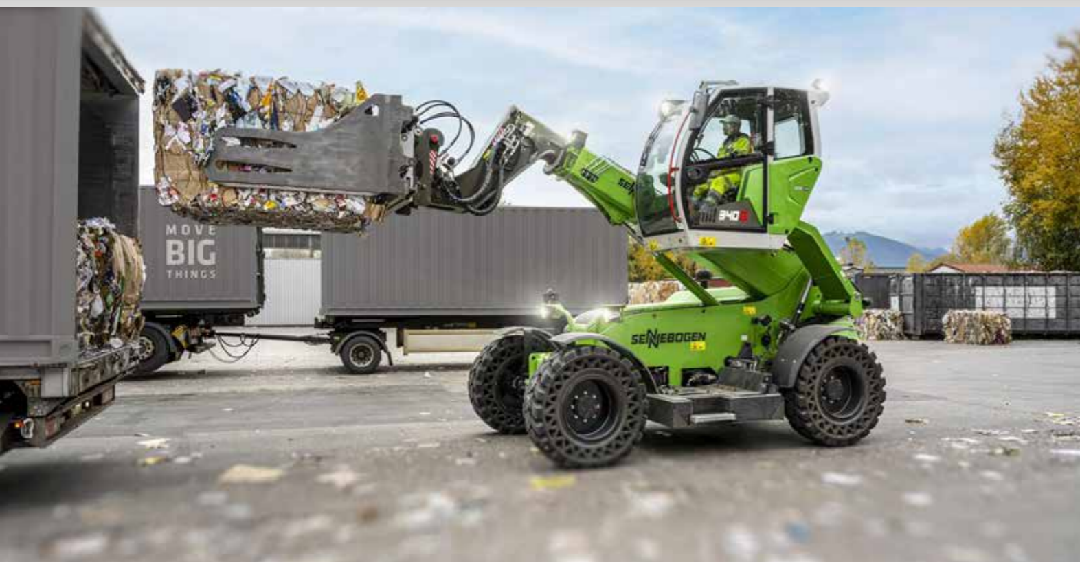
340 G Telehandler - loading of a truck with used paper; Germany 340 G Teleskoplader - LKW-Beladung mit Altpapier; Deutschland
