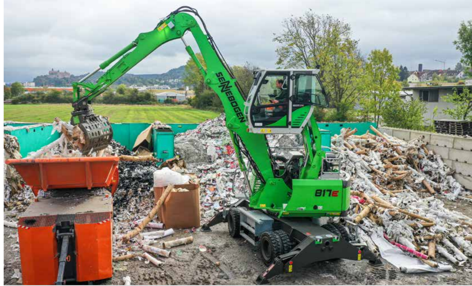
817 M - with sorting grab - loading of shredder; Germany 817 M - mit Sortiergreifer - Schredderbeladung; Deutschland
