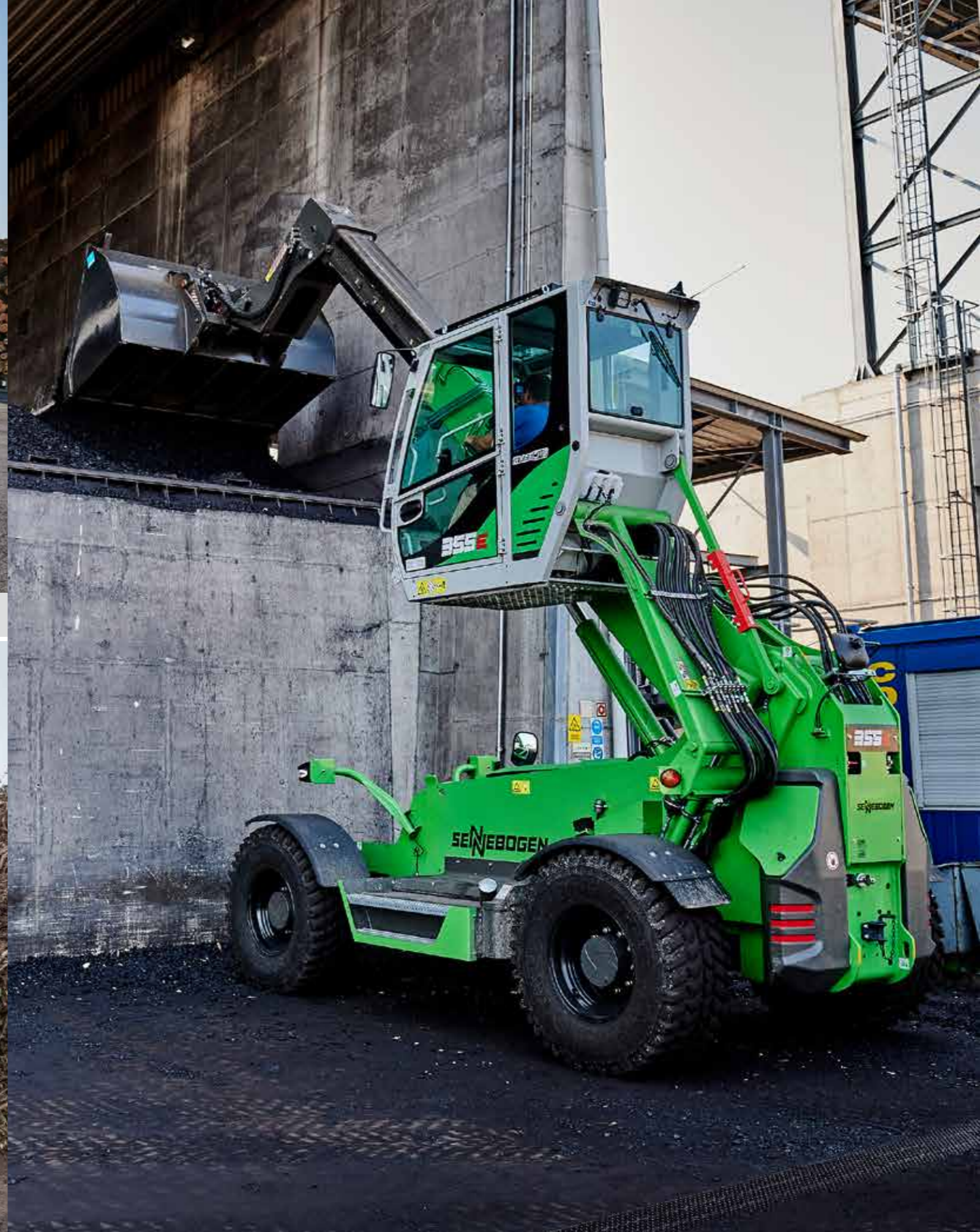
355 E Telehandler - powerful engine under dusty conditions thanks to standard reversible fan; Hungary 355 E Teleskoplader - Leistungsstarker Motor auch bei staubigen Umgebungen dank serienmäßigen Umkehrlüfter; Ungarn
